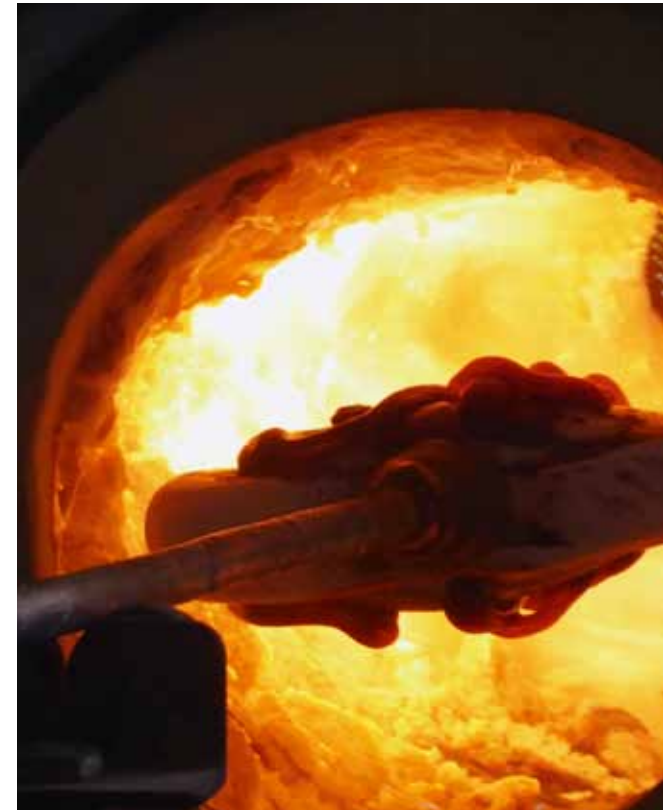
Die Temperatur des heißen Glases darf bei der Herstellung nicht zu stark abfallen, damit die Masse nicht zu zäh und dickflüssig wird. Deshalb wird das Glasobjekt zwischen den einzelnen Arbeitsgängen immer wieder aufgeheizt.
